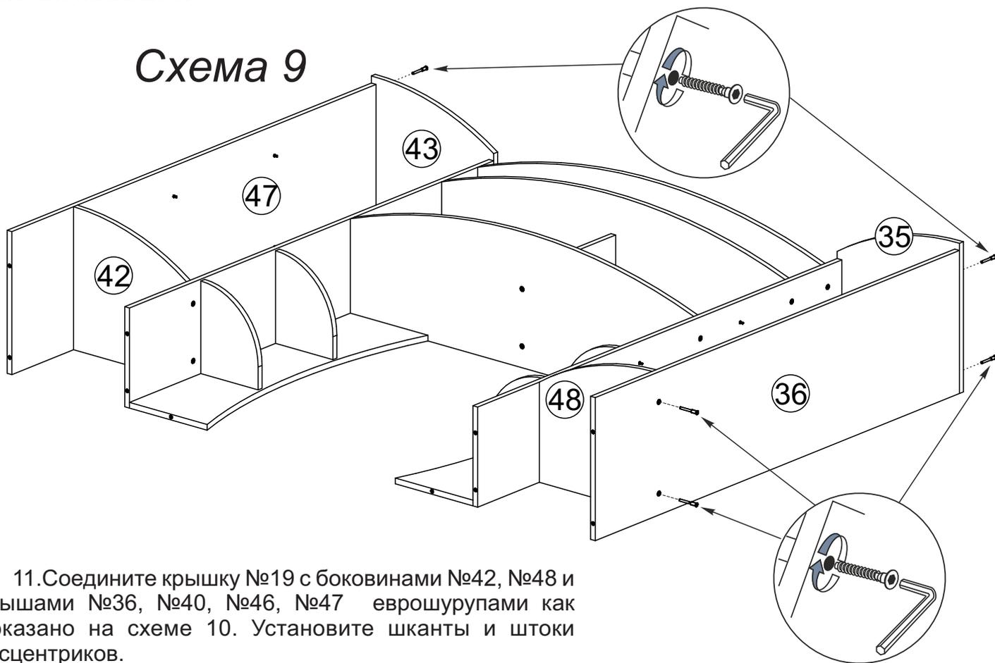
11. Соедините крышку №19 с боковинами №42, №48 и крышами №36, №40, №46, №47 еврошурупами как показано на схеме 10. Установите шканы и штоки эксцентрики.
