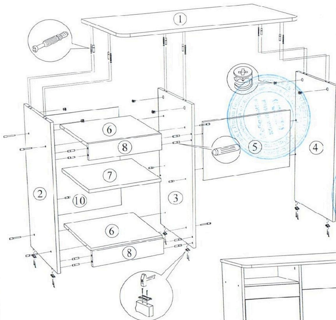
Для правильного открывания створки, необходимо выровнять диагонали каркаса (Рис.1) и только потом прибить ЛДВП не нарушая диагонали.
